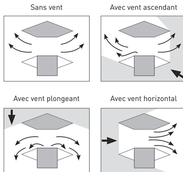
L'extracteur Astato met en application le véritable effet Venturi.
