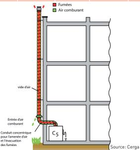
Lors d'une installation d'un conduit concentrique étanche contre une façade, il est recommandé d'utiliser le schéma de raccordement type C5 suivant:
